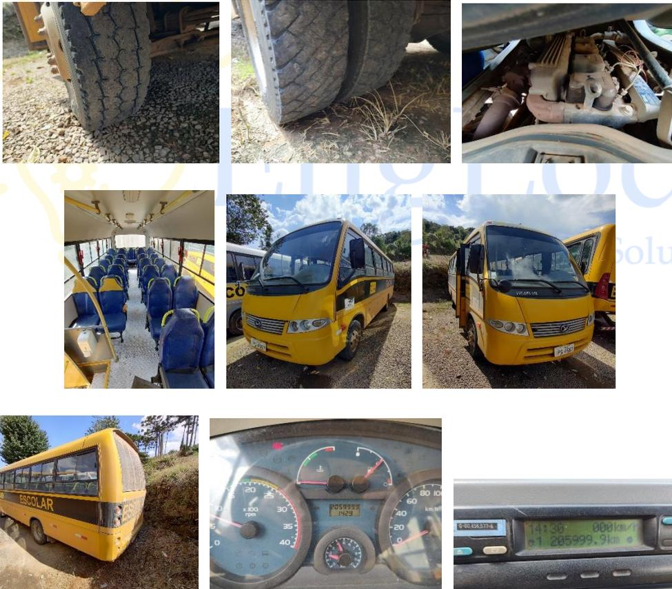
O veículo foi posto em funcionamento, verificou-se que o freio estava funcionando, os faróis em pleno funcionamento, apresenta ruído do motor normal. Encontrado em estado visual bom, possui pneus em meia vida, os bancos encontram-se em bom estado. Veículo está sendo utilizado a serviço da Prefeitura Municipal, onde fez sua última viagem na semana anterior a realização da vistoria.
