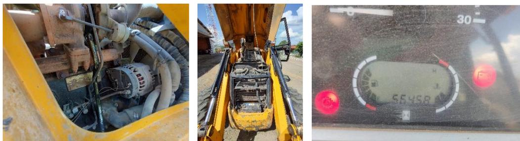
Equipamento foi posto em funcionamento, apresentando ruído do motor normal, com bom desempenho, boas condições de uso. Encontrada em estado visual bom, possui todos os pneus em meia vida. Alguns indícios de pequenos vazamentos na parte hidráulica, todos os comandos funcionam perfeitamente. Cabine fechada com para brisa dianteiro trincado. Tração 4x4 funcionando. Ar condicionado não está funcionando.
